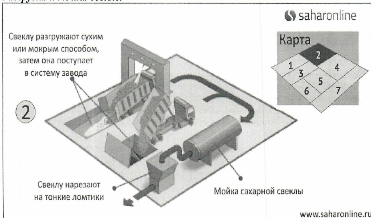
Существуют две системы разгрузки - сухая и мокрая разгрузка. При сухой разгрузки, свекла передается от грузовика на ряд конвейерных лент в бункер
