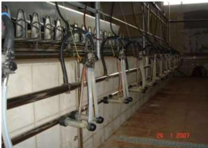
Рис. 6. Универсальный доильный аппарат.
