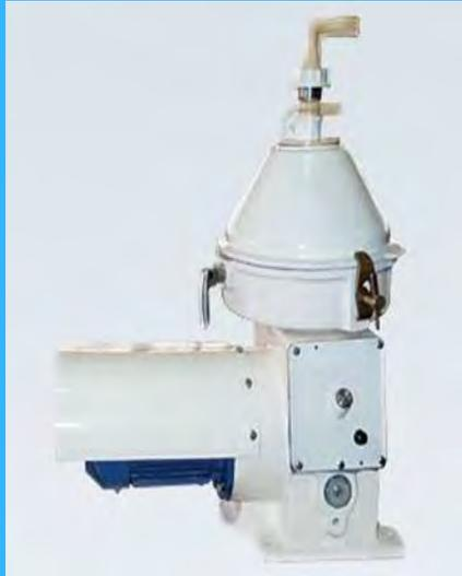
3. Сепаратор - молокоочиститель марки Ж5-Плава-ОСК-1 предназначен для центробежной очистки молока от механических примесей, а также для удаления из молока соматических клеток. Область применения – молочная промышленность, производство сыра, сельхозкооперативы, предприятия по переработке молока малой мощности.
