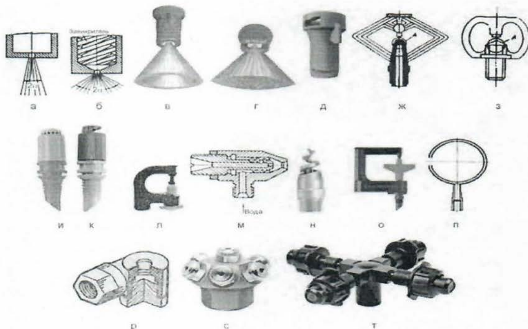
Рис. 4 - Типы форсунок: а – струйная ( 2\alpha = 10 - 15^\circ ); б – центробежная с завихрителями ( 2\alpha = 50 - 110^\circ ); в – струйная с полым коническим факелом; г – струйная с плоским факелом; д – струйная с боковым факелом; ж, з, и, к, л – струйные с отражающим дефлектором; м – центробежная с завихрителем и подсосом воздуха; н – струйная с завихрителем; о – с разбрасывающим диском; п – струйная с соударяющимися струями; р – тангенциальная; с, т – фоггер (блок насадок).
