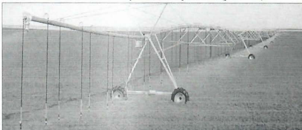
Рис. 8. Микродождевальные насадки в работе на машине «Zimmatic» (Франция)
