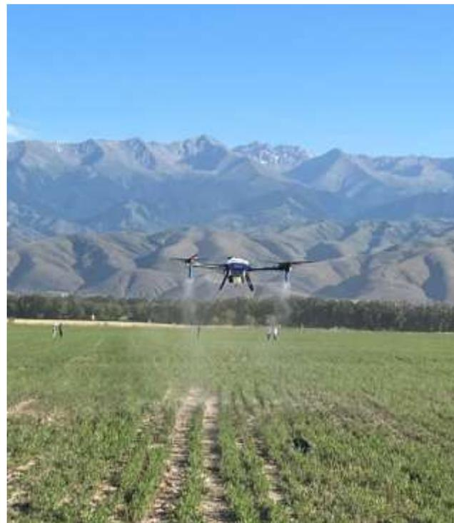
**Сельскохозяйственные дрон опрыскиватель *DJ AGRAS T-10*** опрыскивает поля биологическими препаратами и удобряют почву без повреждения урожая. Дрон способен работать ночью, в паводки и после дождя, на любых типах ландшафтов, что невозможно при традиционных методах обработки, достигают места недоступные тракторам, что позволяет обработать поля более эффективно и быстро.
