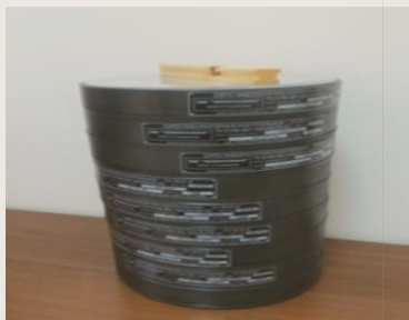
Набор сит контрольных для анализа примесей, клейковины, числа падения зерна (8 сит, поддон, крышка)
