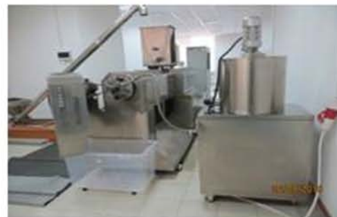
Система совместной работы экструдера-начинкозаполнителя
