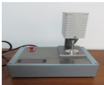
Измеритель деформации клейковины ИДК-3М
