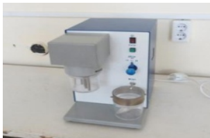
Тестомесилка лабораторная У1-ЕТК-1М
