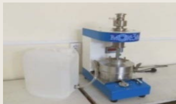
Устройство для механизированного отмывания клейковины марки У1-МОК-3М
