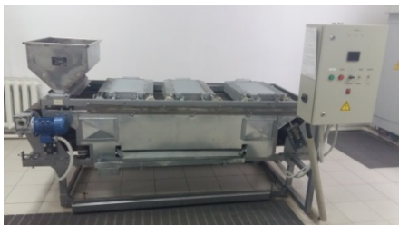
Установка для обработки зерна ИК излучением УТЗ-4 (микронизатор)
