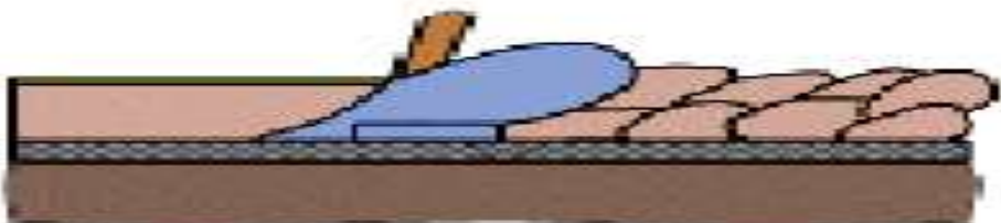
Образование плужной подошвы при работе лемешного плуга
