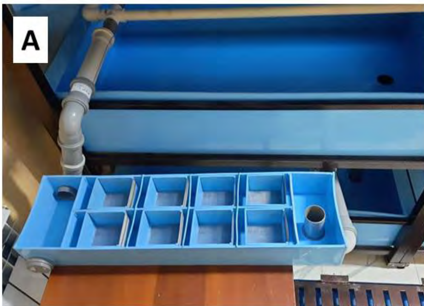
А – один инкубационный модуль; Б – монтаж инкубационного блока из нескольких модулей Рисунок – Монтаж инкубационного блока
