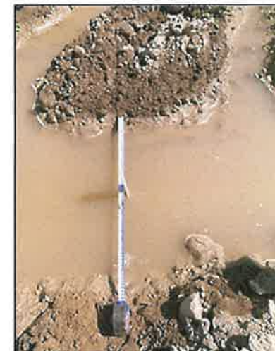
Сурет 11. Суармалы алқаптарда су ағынының жылдамдығы мен көлемі анықталу процесі
